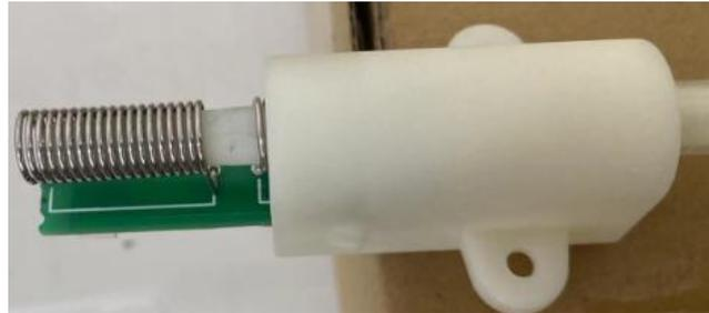
将传感器的弹簧套在被测水管上，推入固定外壳中，传感器检测管内被测物变化，输出对应的状态。当检测到有水流时输出低电平，检测到有气泡（无水）时输出高电平。
